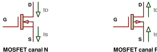
Figure I.2.2.a : Symbole électrique d'un MOSFET à déplétion
