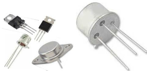
**Figure I.2.b : Transistors bipolaires**
