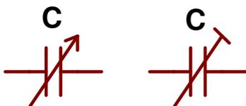
Figure II.2.e : Symboles d'un condensateur variable
