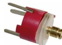
Figure II.2.f : Condensateur rotatif
